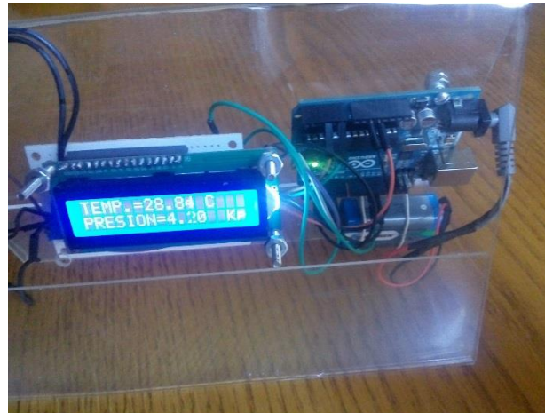
Figura 7. Sistema lector de sensores de presión y temperatura
